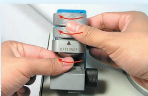
1. Установите патрон с фрезой в установочное гнездо и проворните по часовой стрелке до упора так, чтобы контрольная выемка на гайке была напротив установочной метки.
