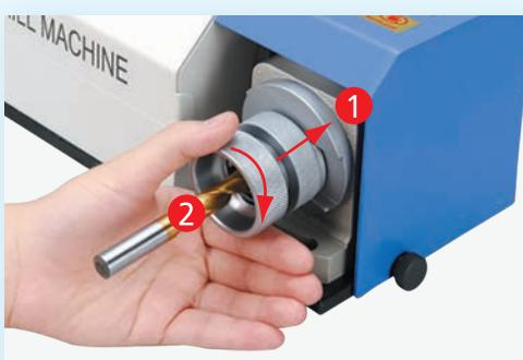
1. **Вставьте цанговый патрон** в гнездо для заточки (см. 1) так, чтобы грани выемки на цанговом зажиме уперлись в специальные шпильки гнезда и установите сверло в отверстие, но не упираите сверло в алмазный круг.
